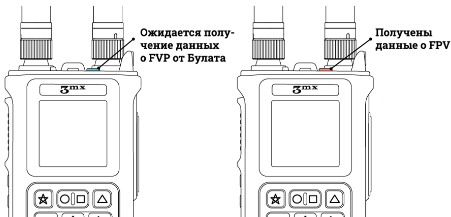
Рис. 23. Индикация светодиода приемника аналогового видеосигнала
