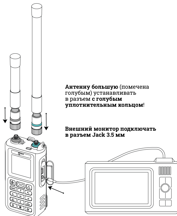
Рис. 3. Установка антенн и подключение внешнего монитора
