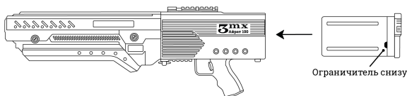
Рис. 4. Установка аккумулятора в подаватель.
