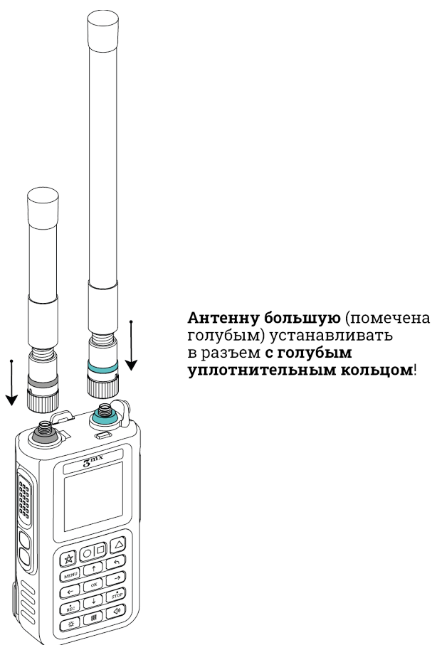
Рис. 4. Установка антенн на мониторинговое устройство
