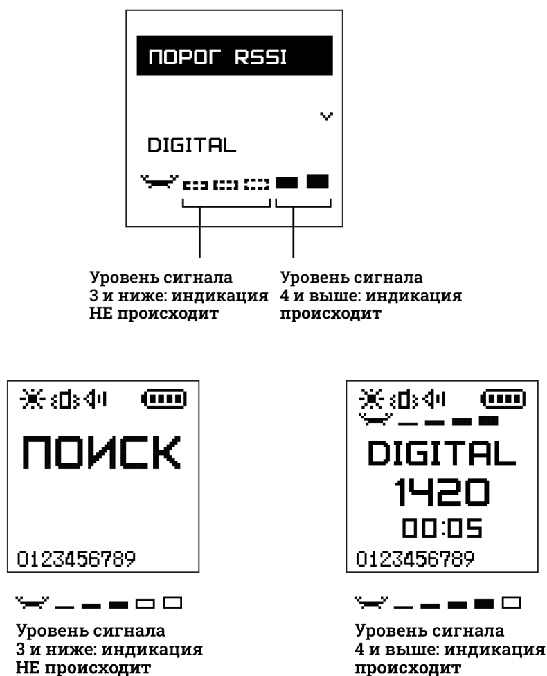
Рис. 21. Принцип обнаружения при настройке порога RSSI
