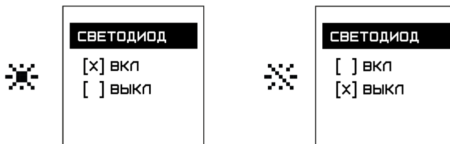
Рис. 31. Подраздел меню «Светодиод» и соответствующие иконки из строки состояния
