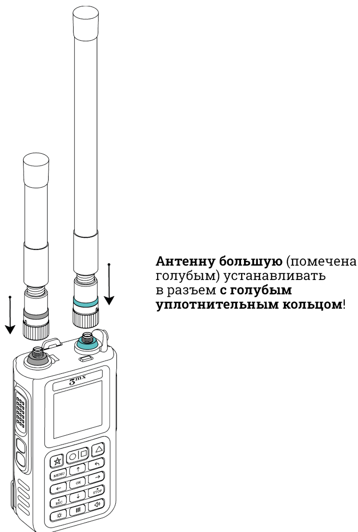
Рис. 4. Установка антенн на мониторинговое устройство
