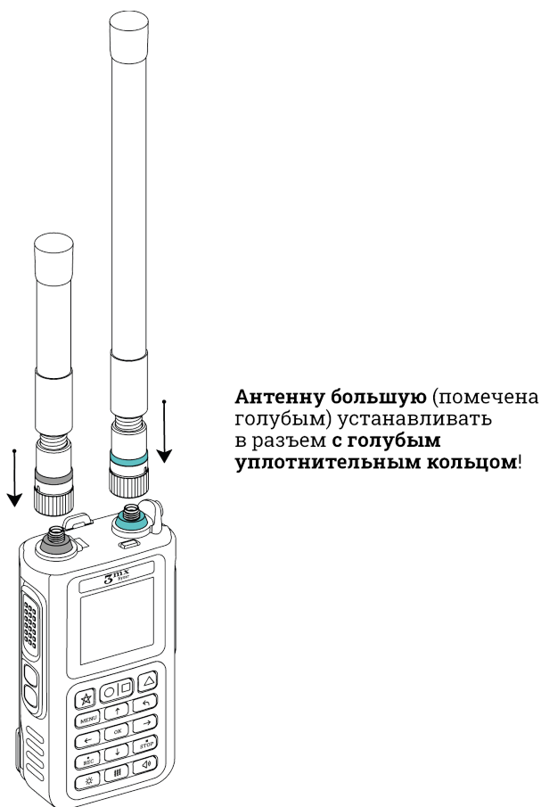
Рис. 4. Установка антенн на мониторинговое устройство
