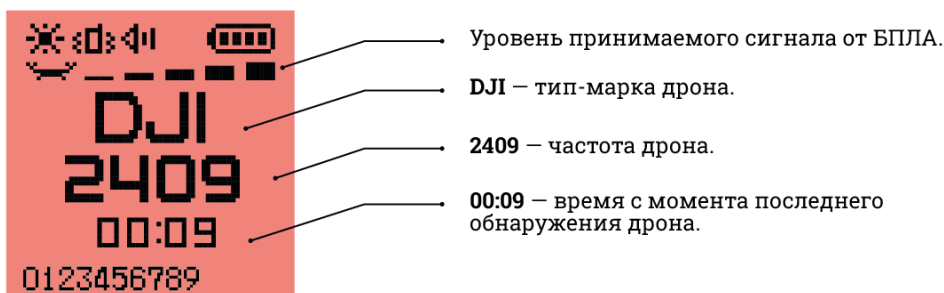
Рис. 9. Обнаружен БПЛА (Классика)
