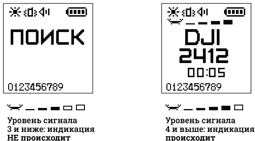
Рис. 25. Принцип обнаружения при настройке порога RSSI
