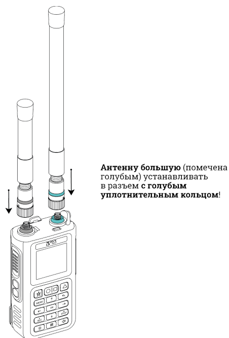
Рис. 4. Установка антенн на мониторинговое устройство
