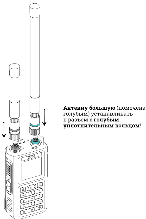
Рис. 4. Установка антенн на мониторинговое устройство
