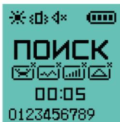
Рис. 3. Главный экран мониторингового устройства
