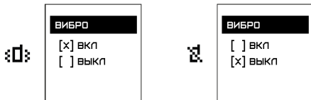
Рис. 12. Подраздел меню «Вибро» и соответствующие иконки из строки состояния
