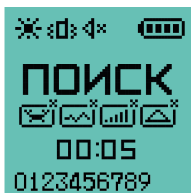
Рис. 3. Главный экран мониторингового устройства
